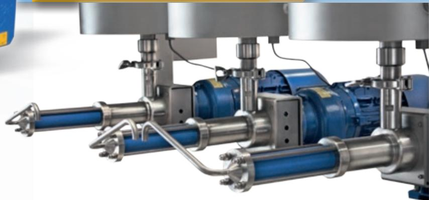
Komplette Abfüll- und Dosieranlagen für genaues Abfüllen von Kleinstmengen.
